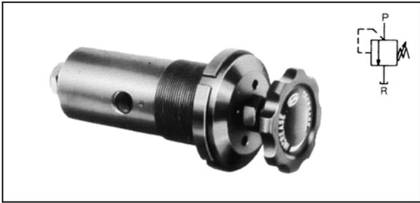
该阀主要用于与平衡活塞式溢流阀的泄油口 (VE) 相连接, 对主回路的压力进行远程操作。另外, 当流量较小时, 也可作为直动式溢流阀使用。
