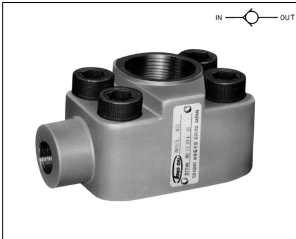
该单向阀将用于防止柱塞泵反转的单向阀和泵出口侧的法兰组合成一体，以减少管道安装的工数和安装空间。
