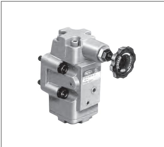
このバルancing弁は、負荷の大きな主軸頭の上下駆動を円滑に行うため、任意のバランス圧を供給する新しい複合圧力制御弁です。この弁は減圧弁、リリーフ弁機能を組み合わせた回路機能をコントロールでき、しかも1つのハンドルで任意のバランス圧を制御することができます。
