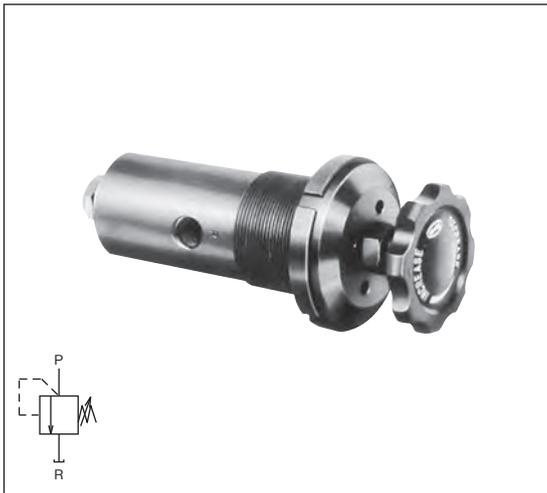
この弁は主としてバランスピストン形のリリーフ弁のベントポート(VE)に接続して主回路の圧力を遠隔操作する場合に使用します。また、少流量の場合は直動形リリーフ弁としても使用できます。
