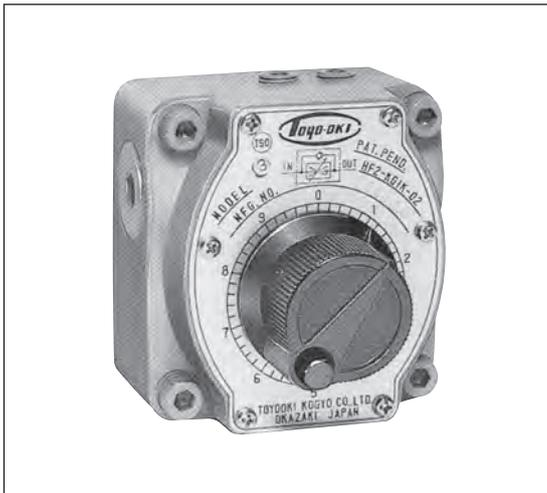
この弁は油の通過断面積を変えて流量を制御する弁ですが、圧力補償機構と温度補償機構を内蔵していますので入口側および出口側の圧力変動に対して、また温度変化による油の粘性変化に対して無関係に一定の制御流量を維持します。さらに絞り機構に工夫をこらしていますので30cm<sup>3</sup>/minから制御できます。
