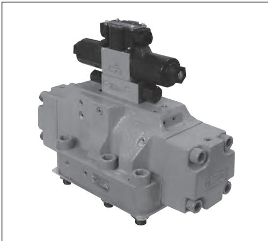
この弁は電磁切換弁と低ショック機能を持たせた油圧切換弁を結合した切換弁で、大流量の切換時のショック、振動、騒音、サージ圧を防止します。
