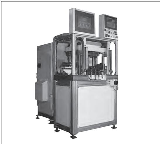
独自の歪修正アルゴリズムとトヨバックモーション(電油サーボシステム)により、修正能力向上、省エネ、省スペース化を実現。
