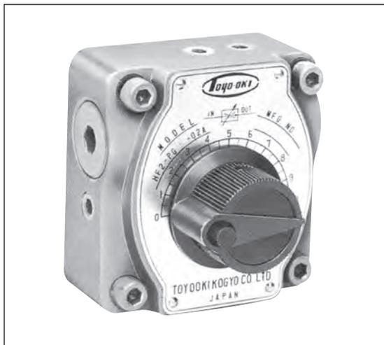
この弁は油の通過断面積を変えて流量を制御する弁ですが、圧力補償機構を内蔵していますので入口側および出口側の圧力が変動しても一定の制御流量を維持します。
