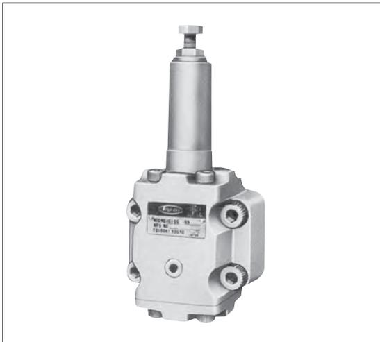
この弁は油圧回路の一部の圧力を、主圧力よりも低い圧力にする場合に使用します。この時、主回路の圧力が変動しても減圧回路の圧力を規定された一定圧力に維持します。
