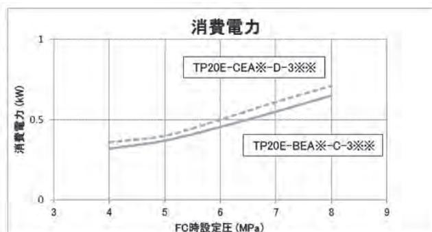
条件 ● 作動油: ISO VG32 ● 油温: 50℃ ● 電源: AC200V60Hz
