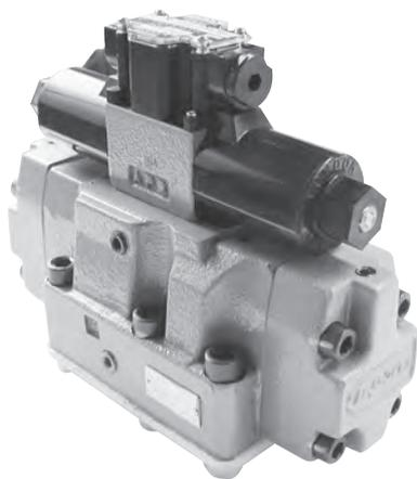
この弁は電磁切換弁と油圧切換弁を結合した切換弁で、電磁切換弁により制御されるパイロット圧力により油圧切換弁(主弁)を操作し、主回路の圧油の流れ方向を切換えます。
