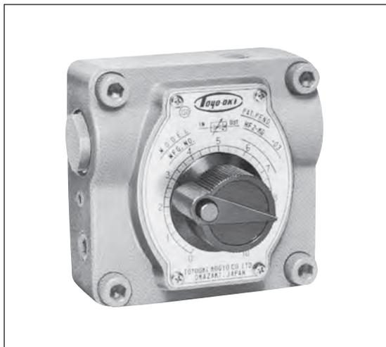
この弁は油の通過断面積を変えて流量を制御する弁ですが、圧力補償機構と温度補償機構を内蔵していますので、入口側および出口側の圧力変動に対して、また温度変化による油の粘性変化に対して無関係に一定の制御流量を維持しますので特に正確な速度制御に対して最適です。
