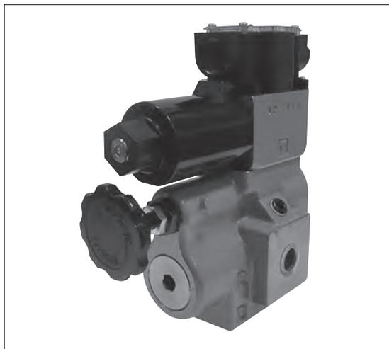
この弁はリリーフ弁とリリーフ弁のベントポート(VE)に設ける電磁切換弁を一体に組付けたもので、リリーフ弁の動きと同時にベントポートを開閉してアンロード操作を行なえます。
